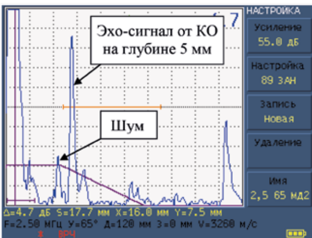
Типовые А-Сканы, получаемые при выявлении КО на глубине 5 и 20 мм в образце МД2-0-1 ПЭП типа П121-2,5-65-В5-03
