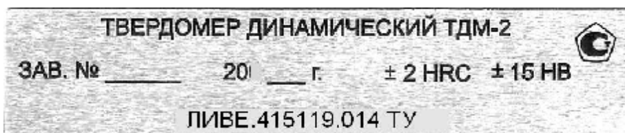
Рисунок 2 - Шильдик задней панели со знаком утверждения типа.
