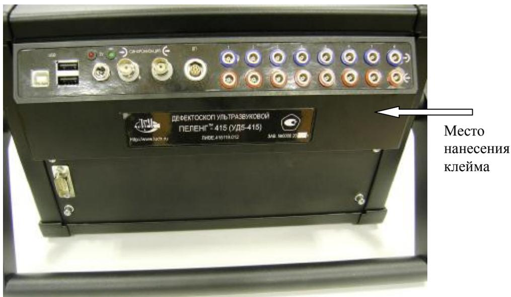
Рисунок 2 – Место нанесения клейма.
