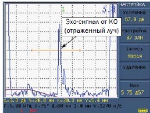
**ТИПОВЫЕ А-СКАНЫ, ПОЛУЧАЕМЫЕ ПРИ ВЫЯВЛЕНИИ ЗАРУБКИ 1,8×0,65 ММ
