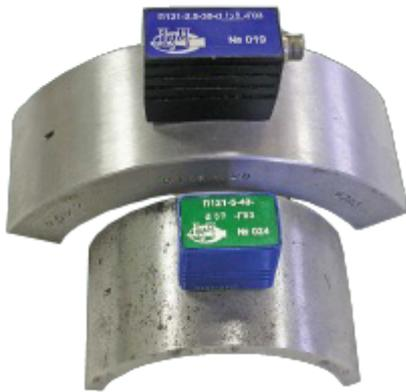
**14. Преобразователи наклонные контактные совмещенные типа П121 для контроля труб малого диаметра**
