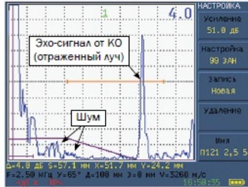
**ТИПОВЫЕ А-СКАНЫ, ПОЛУЧАЕМЫЕ ПРИ ВЫЯВЛЕНИИ ЗАРУБКИ 1,4×1 ММ В СОП Ø38×5 ПРЯМЫМ И ОТРАЖЕННЫМ ЛУЧАМИ ПЭП ТИПА П121-5-55-D38-03**
